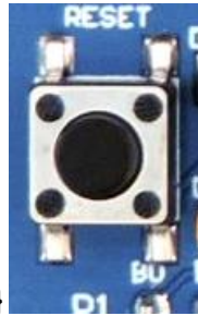
Imagen 6. Fotografía del pulsador de RESET.
