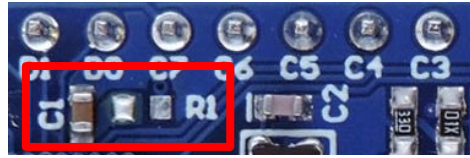
Imagen 5. Fotografía del puerto C3 con su capacitor de 0.22uF (PIC con módulo de comunicaciónUSB).
