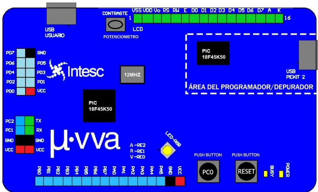
Imagen 2. Diseño y disposición física de la tarjeta
