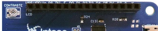
Imagen 6. Fotografías del puerto de expansión para Display LCD.
